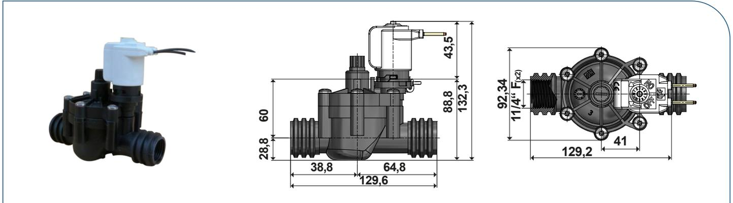
**Merkmale:** Vorgesteuertes Membranventil mit Handhilfsbetätigung und einstellbarer Durchflussregelung. Das Magnetventil benötigt zum Betrieb eine Druckdifferenz von mindestens 0,5bar. Die Ventile der Serie 3 werden vorwiegend für Bewässerungssysteme in Gewächshäusern, Reithallen, sowie in der Industrie eingesetzt.
