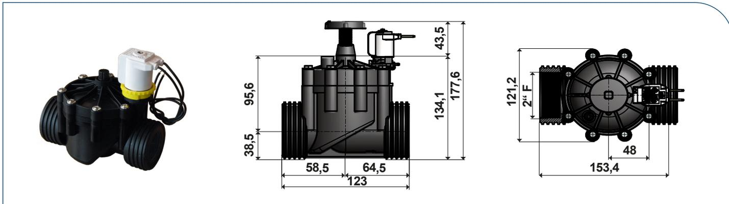
**Merkmale:** Vorgesteuertes Membranventil mit Handhilfsbetätigung und einstellbarer Durchflussregelung. Das Magnetventil benötigt zum Betrieb eine Druckdifferenz von mindestens 0,5bar. Die Ventile der Serie 3 werden vorwiegend für Bewässerungssysteme in Gewächshäusern, Reithallen, sowie in der Industrie eingesetzt.
